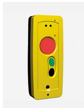
Bild 6 Beispiel eines Personenüberwachungsgerätes mit Lageüberwachung und manuellem Notruf
